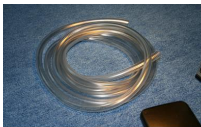
Tubo di plastica trasparente: diametro interno ca. 12 mm
